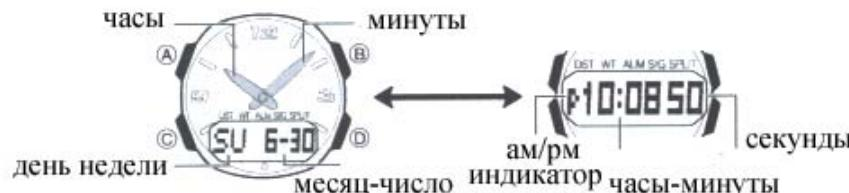
На рисунке изображен общий вид часов в Режиме Текущего Времени. Нажмите кнопку “C” для перехода из разряда в разряд в следующей последовательности:
