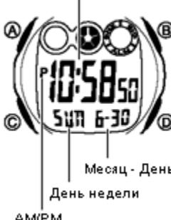
На рисунке изображен общий вид часов в Режиме Текущего Времени. Нажмите кнопку "С" для перехода из режима в режим в следующей последовательности: Режим Текущего Времени – Режим Звукового Сигнала – Режим Таймера Обратного Отсчета - Режим Секундомера – Режим Двойного Времени – Режим Текущего Времени.
